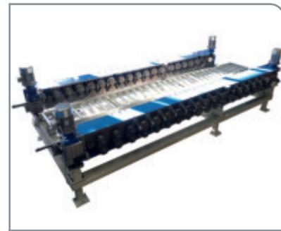
Walzprofilierungseinheit für selektierte integrierte Anformflanschen
