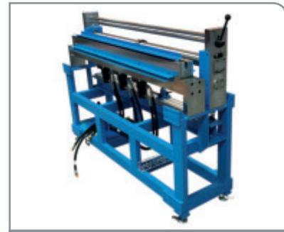
Kombinierte automatische Schneid- und Stanzeinheit
