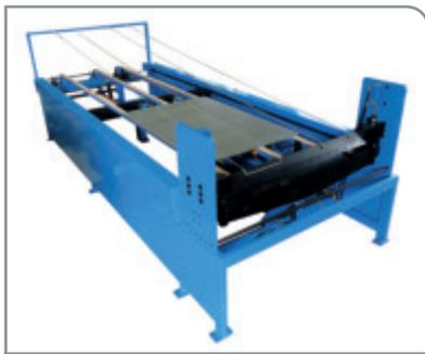
Automatische Falz- (und Verschluss) Einheit
