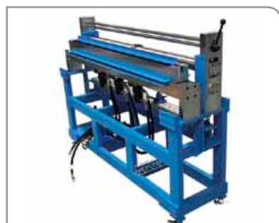
Unité de découpe et système de poinçonnage automatiques combinés
