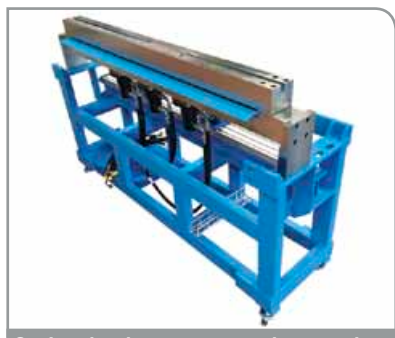
Système de poinçonnage automatique pour tirant
