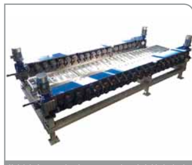
Unité de formage à galets pour système de bride intégrée
